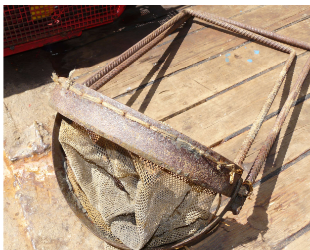
Рисунок 7 – Водолазный модифицированный дночерпатель в сложенном состоянии (слева) и в рабочем положении перед взятием пробы под водой (справа) (из: Дуленин, 2017)
