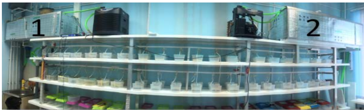
Рис. 4.1. Общий вид установки для разведения рыб с экспериментальными целями. Обозначения: 1. Аквариум водоподготовки в термоизолирующей пленке и блок установки для содержания морских рыб (уровень 1 сверху). 2. Аквариум водоподготовки в термоизолирующей пленке и блок установки для содержания пресноводных и проходных рыб (уровень 1 сверху). Рядом с аквариумами расположены водные охладители (холодильники); правый охладитель показан без внешнего кожуха. Ниже последовательно сверху вниз для рядов 2 и 3 показаны боксы для содержания икры и личинок (по 3 блока из 12 боксов для потомства диаллельной 2×2 системы скрещивания); для ряда 3 показаны мини аквариумы для содержания молоди рыб.
